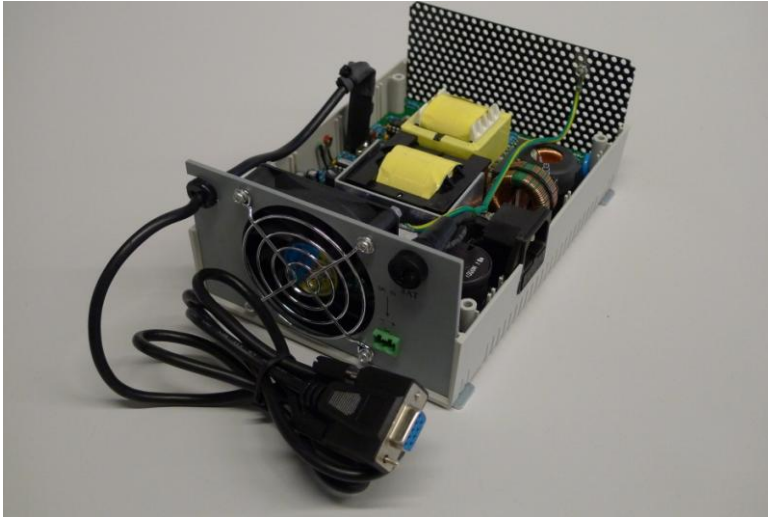
De inverter met RS-232 kabel.
